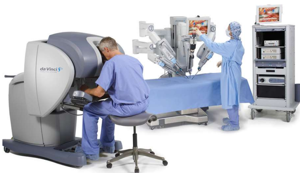
Operační systém Da Vinci (zleva: ovládací konzole, operační konzole a přístrojová věž)
