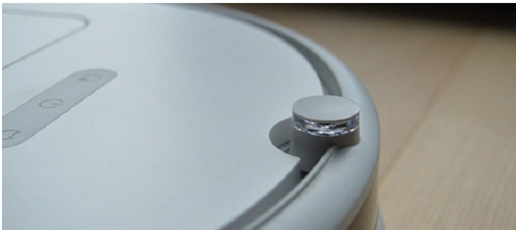
Obrázek 2: Sensor v podobě radaru.
