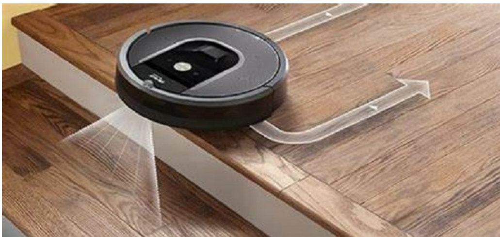
Obrázek 4: Sensor volného prostoru pod robotem.
