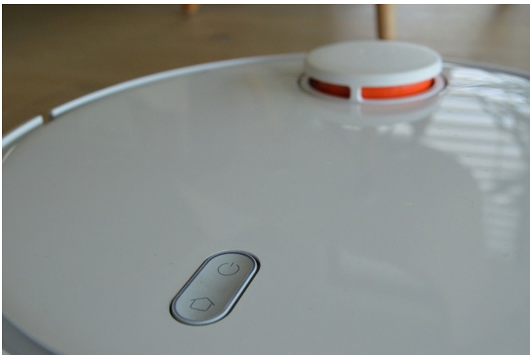
Obrázek 3: Sensor v podobě radaru s laserovým senzorem vzdálenosti.
