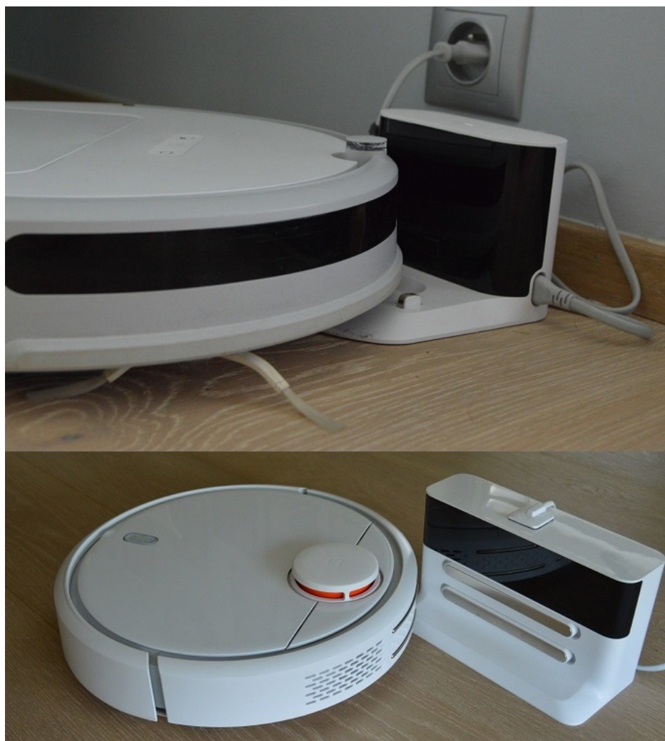
Obrázek 8: Konektory vespod versus konektory na boku.
