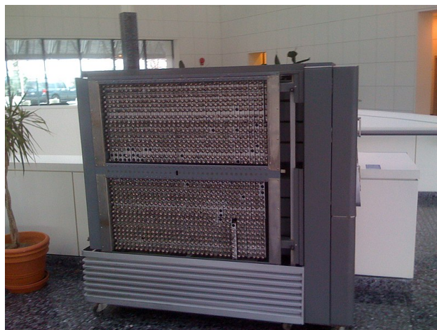
Obrázek 1: Procesorová elektronková jednotka počítače IBM 701, Autor: pdx-diver, Licence: CC-BY-SA 2.0
